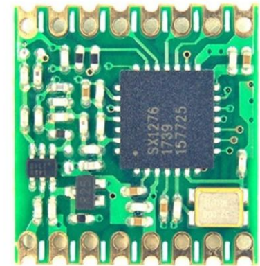
LoRa Module: SX1276 868MHz band
