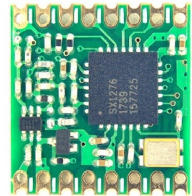
LoRa Module: SX1276 868MHz band
